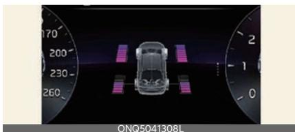
Se muestra el estado de distribución de la potencia de tracción de las ruedas delanteras y traseras.
