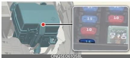
Con el fusible tipo plano desconectado, retírelo utilizando el clip diseñado para cambiar fusibles situado en la caja de fusibles del compartimento del motor. Tras retirarlo, inserte de forma segura un fusible inverso de igual cantidad.
