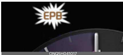
Si el testigo de avería del EPB permanece encendido, se enciende durante la conducción o no se enciende cuando el vehículo se encuentra en la posición «ON» (Encendido), significa que hay una posible avería en el EPB.
