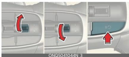
Pulse el interruptor +, - o el botón (Ⓢ). Si empuja el interruptor + hacia arriba o el interruptor - hacia abajo, la velocidad del vehículo se ajustará a la velocidad actual en el tablero. Si pulsa el botón (Ⓢ) la velocidad del vehículo se reanudará al valor prefijado. La velocidad del vehículo debe ser superior a 30 km/h (20 mph) para que se reanude el control de cruceo.
