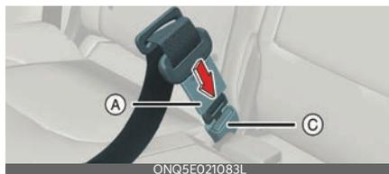
4. Tire de la placa de la lengüeta (C) e inserte la placa de la lengüeta en el extremo abierto de la hebilla (D) hasta que se escuche un "clic", indicando que el pestillo está bloqueado. Com-
