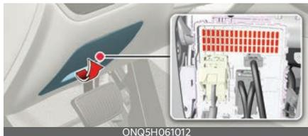
3. Tire del fusible averiado. Utilice la herramienta de desmontaje (1) que se encuentra en la caja de fusibles principal del compartimento del motor.
