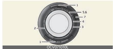
Esta información identifica y describe las características fundamentales del neumático y proporciona su número de identificación (TIN) para certificar el estándar de seguridad. El TIN se puede usar para identificar el neumático en caso de retirada.
