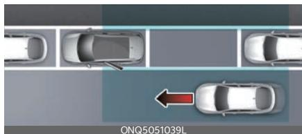
Después de detener el vehículo, si se detecta un vehículo que se aproxima desde el área trasera y un pasajero abre la puerta, el aviso de salida segura avisará al conductor con un mensaje de advertencia y un sonido de advertencia para ayudar a evitar una colisión.
