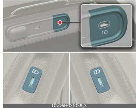
El cargador USB del vehículo permite a los conductores y los pasajeros cargar sus dispositivos digitales como teléfonos inteligentes y tabletas PC.
