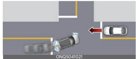
La función de giro en cruce ayudará a evitar una colisión con un vehículo que circula de frente por un carril adyacente al girar a la izquierda (conducción a la izquierda) o a la derecha (conducción a la derecha) en un cruce con el intermitente activado mediante el accionamiento del freno de emergencia.
