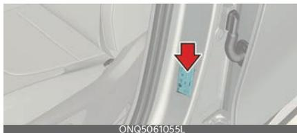
La etiqueta de los neumáticos situada en la columna central, tal como se muestra, indica la presión de los neumáticos recomendada para el vehículo. Los neumáticos de su nuevo vehículo se han elegido para ofrecer el rendimiento óptimo durante la conducción normal.
