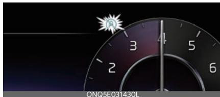
El sistema ISG se indica mediante el indicador AUTO STOP (A) en el tablero de instrumentos.
