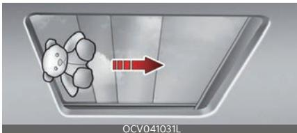
Si el parasol eléctrico o el techo solar detectan algún obstáculo mientras se cierra automáticamente, invertirá la dirección y se detendrá en una posición determinada.
