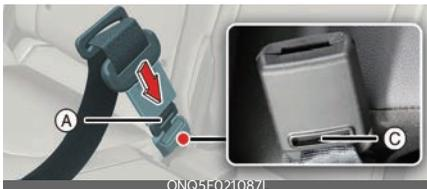
3. Inserte la placa de la lengüeta en el soporte (1) en el cinturón de seguridad y luego inserte la mini lengüeta en el orificio de la tapa del conjunto del cinturón (2).
