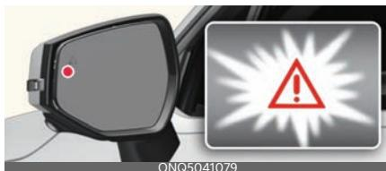
El testigo de advertencia se mostrará en el espejo retrovisor exterior cuando se detecte el vehículo en ambos carriles desde la parte trasera.
