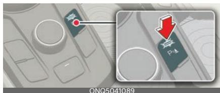
Pulse el botón Seguridad de estacionamiento (P) para activar o desactivar la advertencia de la distancia de estacionamiento marcha atrás.
