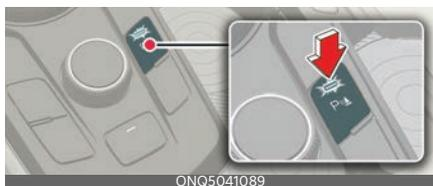
Pulse el Botón Seguridad de estacionamiento (P+) para activar o desactivar la Advertencia de la distancia de estacionamiento hacia delante/marcha atrás.
