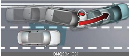
Al cambiar de carril detectando el carril hacia delante, si la asistencia de prevención de colisión en punto ciego considera que existe un riesgo de colisión con un vehículo que se aproxima por el punto ciego, la función ayudará a evitar la colisión accionando el freno.
