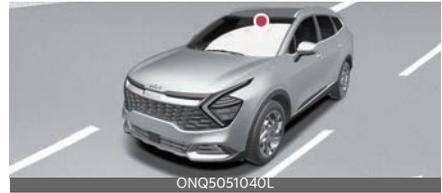
La cámara de visión frontal se utiliza como sensor para detectar las marcas del carril y los vehículos que están delante.
