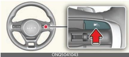
Pulse el botón de asistencia al conductor
