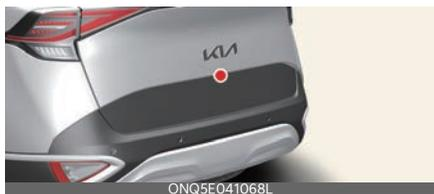
La cámara de visión trasera se utiliza como sensor de detección para detectar peatones. Si la lente de la cámara está cubierta por sustancias extrañas, como nieve o lluvia, esto podría afectar negativamente al rendimiento de la cámara y es posible que la asistencia de prevención de colisión en estacionamiento marcha atrás no funcione con normalidad. Mantenga siempre limpia la lente de la cámara.
