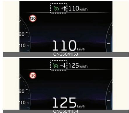
Si el límite de velocidad de la carretera cambia durante el funcionamiento de la asistencia de límite de velocidad manual o del Control de crucero inteligente (si está equipado), se muestra una flecha en el sentido hacia arriba o hacia abajo para informar al conductor de que es necesario cambiar la velocidad fijada. En este momento, el conductor puede cambiar la velocidad fijada de acuerdo con el
