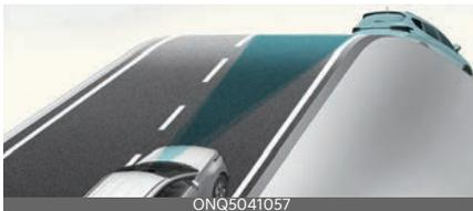
Durante la conducción en cuestas hacia arriba o hacia abajo, el control de cruceo inteligente podría no detectar el vehículo que se desplaza por su carril y su vehículo podría acelerar hasta la velocidad fijada. Además, la velocidad del vehículo se reducirá rápidamente cuando se detecte el vehículo que está delante de forma repentina.
