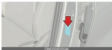
La etiqueta de certificación del vehículo situada en la columna central, tal como se muestra, indica el número de identificación del vehículo (VIN).
