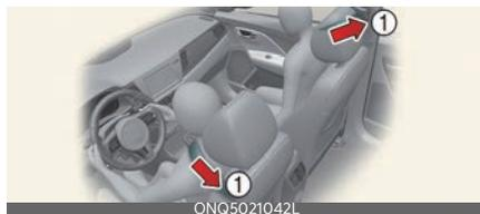
El vehículo viene equipado con pretensores de los cinturones de seguridad del conductor y del acompañante.
