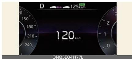
Si se requiere una desaceleración temporal en el estado de espera y el control de crucero inteligente basado en la navegación está en funcionamiento, el símbolo verde (NAV) se encenderá en el tablero.
