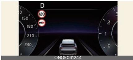
La información del límite de velocidad se muestra en el tablero de instrumentos.
