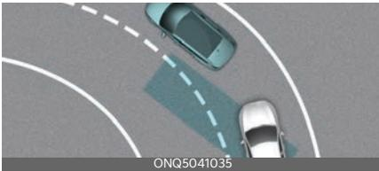
Es posible que el aviso de colisión en punto ciego no se accione correctamente al conducir por una carretera con curvas. El Aviso de colisión en punto ciego podría detectar un vehículo que circula por el mismo carril. Preste siempre atención a la carretera y a las condiciones de la conducción.
