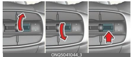
Para reanudar la asistencia para límites de velocidad manual después de realizar una pausa en la función, empuje el interruptor +, -, (1).
