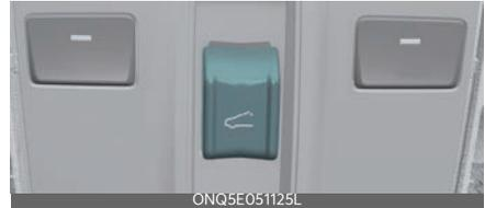
El techo solar solo puede accionarse cuando el interruptor de encendido o el botón ENGINE/START STOP (inicio/parada del motor) está en la posición ON (activado) o START (arranque).
