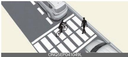
Si hay peatones o bicicletas entre usted y el vehículo que le precede, es posible que el aviso de movimiento del vehículo de delante no funcione correctamente.
