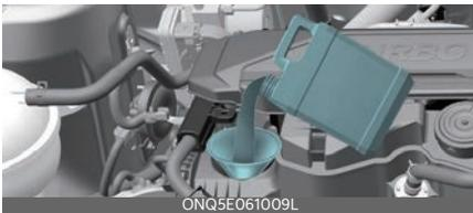
Utilice un embudo para evitar que el aceite se derrame por los componentes del motor.
