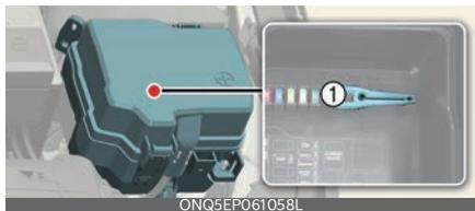
4. Compruebe los fusibles que ha extraído; reemplace los fundidos. Los fusibles de recambio están colocados en el panel de fusibles del panel de instrumentos (o en el panel de fusibles del compartimento del motor).
