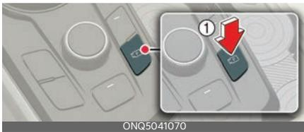
Pulse el botón de estacionamiento/visión (1) para activar o desactivar el monitor de visión trasera.
