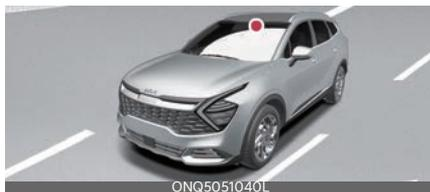
La cámara de visión frontal se utiliza como sensor para detectar las marcas del carril (o los bordes de la calzada). Consulte la imagen anterior para la ubicación detallada del sensor de detección.
