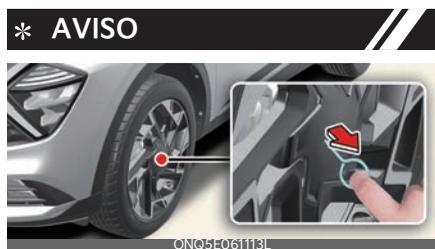
Para las ruedas de 19 pulgadas, utilice la herramienta de extracción del equipo de cambio de neumáticos en carretera. Introduzca la herramienta en el orificio y extraiga la cubierta de la rueda.
