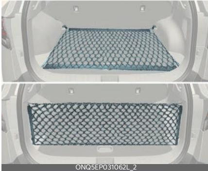
Hay 4 soportes en el área de carga. La red de equipaje (si está equipado) puede fijarse de 2 maneras.
