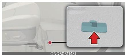
Asegúrese de que la alfombra quede acoplada a los anclajes para que no se deslice hacia delante.
