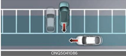
La Asistencia de prevención de colisión con tráfico cruzado trasero puede detectar vehículos que pasen por detrás cuando estacione marcha atrás en una plaza de estacionamiento. Si esto ocurre, la función podría avisar al conductor de forma innecesaria y controlar el freno.
