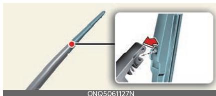
Si se ha finalizado el reemplazo, baje el brazo del limpiaparabrisas para colocarlo en el parabrisas trasero, coloque el encendido del vehículo en ON y accione los limpiaparabrisas para verificar que la escobilla se ha colocado correctamente.
