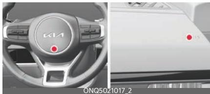
La presencia del sistema se indica con las letras "AIR BAG" grabadas en la cubierta del panel del airbag en el volante y el panel frontal del lado del acompañante sobre la guantera.
