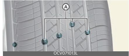
A: Indicador de desgaste de banda de rodadura
