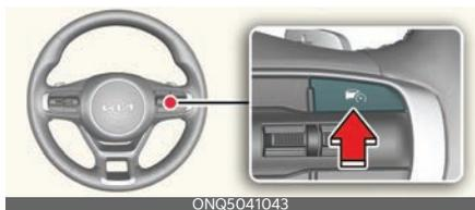
Pulse el botón de asistencia al conductor (🚗) para desactivar el sistema de control de cruceo inteligente.
