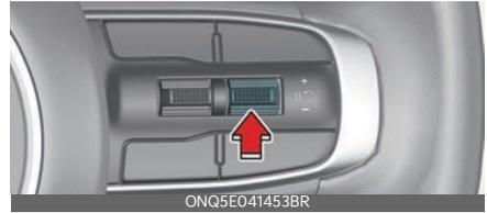
Empuje el interruptor (1) para realizar una pausa de forma temporal en el límite de velocidad definido. El límite de velocidad definido se desactivará, pero el indicador de límite de velocidad (LIMIT) permanecerá encendido.
