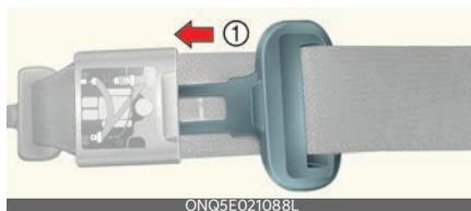
3. Introduzca la mini lengüeta (A) en el extremo abierto del conector del anclaje (B) hasta que se escuche un "clic", indicando que el enganche está bloqueado. Compruebe que el cinturón no esté torcido.
