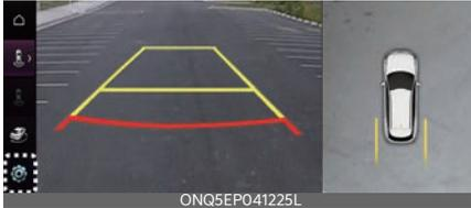
Con el vehículo encendido, seleccione el icono de configuración (⚙️) en la pantalla o **Ajustes** → **Vehículo** → **Asistencia al conductor** → **Seguridad de estacionamiento** → **Ajustes de la cámara** de la pantalla del sistema de infoentretenimiento para cambiar los ajustes del monitor de visión trasera.
