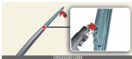
6. Monte un nuevo conjunto de la escobilla colocando la parte central en la ranura del brazo del limpiaparabrisas hasta que encaje en su sitio.
