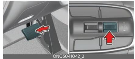
Pulse el interruptor (||◻) o pise el pedal del freno para cancelar de forma temporal el control de crucero inteligente.
