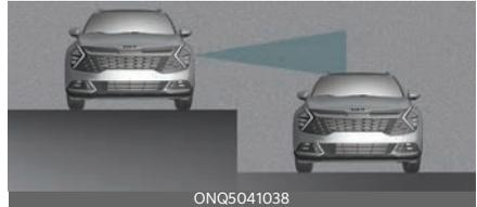
Es posible que la asistencia de prevención de colisión en punto ciego no funcione correctamente al conducir por carriles que están a distinta altura. La asistencia de prevención de colisión en punto ciego podría no detectar el vehículo en una carretera con carriles a diferentes alturas.
