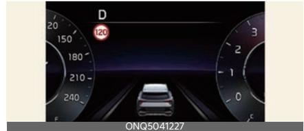
Al conducir a una velocidad superior al límite de velocidad mostrado, el indicador rojo de límite de velocidad parpadeará.
