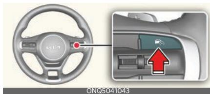
El testigo indicador del límite de velocidad (LIMIT) se encenderá en el tablero.
