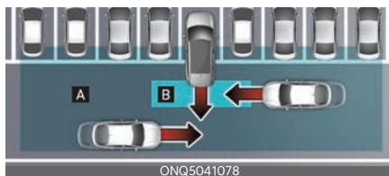
[A]: rango de funcionamiento del aviso de colisión con tráfico cruzado trasero
