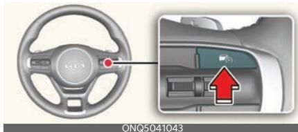
Pulse el botón de asistencia al conductor (Ⓢ) para desactivar el sistema de control de cruceo. El indicador de cruceo (Ⓢ CRUISE) se apagará.
