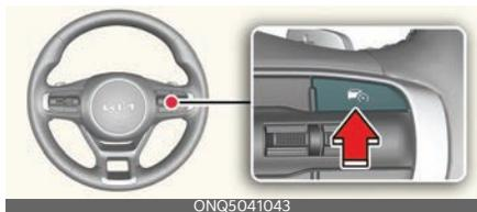
Pulse el botón de asistencia al conductor (🚗) para desactivar la asistencia de límite de velocidad manual. El indicador de límite de velocidad (🚗LIMIT) se apagará.
