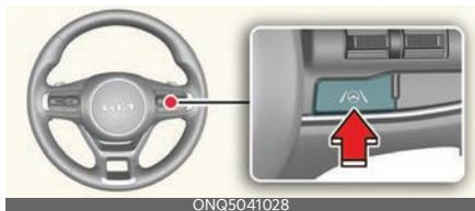
Con el vehículo encendido, pulse brevemente el botón de asistencia al conductor en el carril ubicado en el volante para activar la Asistencia de seguimiento de carril. El testigo indicador gris o verde (Ⓜ) se encenderá en el tablero.
