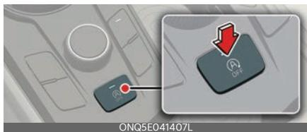
Si desea desactivar el sistema ISG, pulse el botón ISG OFF. El testigo en el botón ISG OFF se encenderá. Si pulsa de nuevo el botón ISG OFF, el sistema se activará y el testigo en el botón ISG OFF se apagará.
