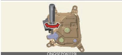
La luz antiniebla delantera puede orientarse del mismo modo que los faros. Con las luces antiniebla delanteras y la batería en estado normal, oriente las luces antiniebla delanteras.
