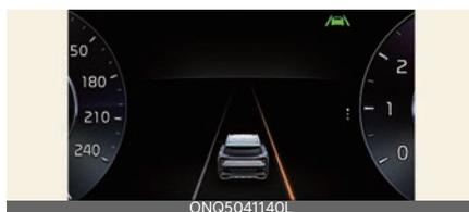
La asistencia de mantenimiento de carril avisa y controla el vehículo con el aviso de salida de carril y la asistencia de mantenimiento de carril.
