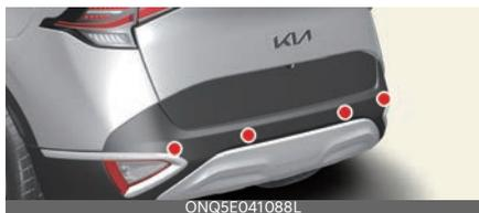
Los sensores ultrasónicos traseros están ubicados dentro del parachoques trasero y permiten detectar objetos en el área trasera. Si los sensores están cubiertos por sustancias extrañas, como nieve o lluvia, esto podría afectar negativamente al rendimiento del sensor y es posible que la asistencia de prevención de colisión en estacionamiento marcha atrás no funcione con normalidad. Mantenga siempre limpio el parachoques trasero.
