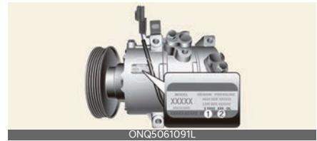
La etiqueta del compresor indica el tipo de compresor con el que está equipado el vehículo, el modelo, el número de pieza, el número de producción, el refrigerante (1) y el aceite refrigerante (2).
