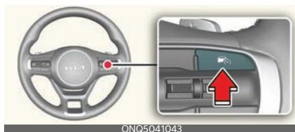
2. Pulse el botón de asistencia al conductor (ASIST) a la velocidad que desea. La velocidad fijada y el indicador de cruceo (CRUISE) se encenderán en el tablero.
