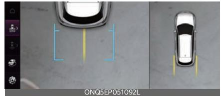
Cuando se selecciona la **Guía de estacionamiento con visión superior**, esta se muestra en el lado derecho de la pantalla del monitor de visión de 360°.
