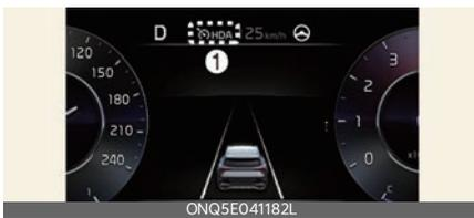
1 Indicador de asistencia de conducción en autopista, si hay un vehículo que le precede y se muestra el nivel de distancia seleccionado.
