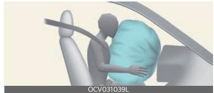
Los módulos del airbag están situados en el centro del volante de la dirección y en el panel del pasajero delantero sobre la guantera. Cuando el SRSCM detecta un impacto fuerte en la parte delantera del vehículo, se desplegarán automáticamente los airbags delanteros.
