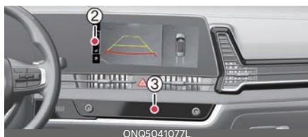
La función de visión frontal se muestra en la pantalla cuando la marcha está en N (punto muerto) o D (conducción) para ayudar a estacionar. La visión frontal tiene una visión superior/visión frontal/visión lateral/visión 3D. Además, es posible seleccionar otros modos de visión tocando los iconos de vista (2) en la pantalla del monitor de vista de 360°.
