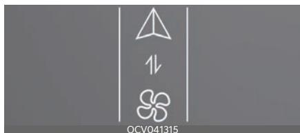
Pulse el botón del mando conmutable para cambiar entre el sistema de infoentretenimiento o el panel de control del clima.
