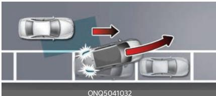
Al conducir hacia delante para salir de una plaza de aparcamiento, si la asistencia de prevención de colisión en punto ciego considera que existe un riesgo de colisión con un vehículo que se aproxima por el punto ciego, la función ayudará a evitar la colisión accionando el freno.
