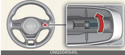
Empuje el interruptor + hacia arriba y suéltelo inmediatamente. La velocidad fijada aumenta 1 km/h (1 mph) cada vez que se acciona el interruptor de esta manera.
