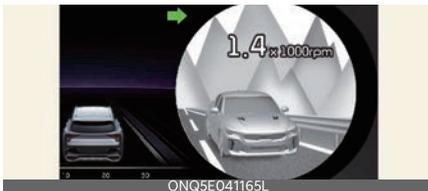
El monitor de vista de punto ciego visualiza el área trasera de punto ciego del vehículo en el tablero cuando se activa el intermitente para ayudar a cambiar de carril con seguridad.
