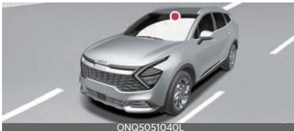
La cámara de visión frontal se utiliza para detectar los patrones de conducción y el inicio de la marcha del vehículo que está delante mientras se conduce el vehículo.
