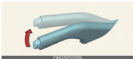
Compruebe el recorrido del freno de estacionamiento contando el número de "clics" que se escuchan mientras lo acciona por completo desde la posición de liberación. Además, el freno de estacionamiento solo debe mantener el vehículo sujeto de forma segura en una pendiente bastante pronunciada. Si tiene un recorrido mayor o menor de lo especificado, le recomendamos que haga inspeccionar el sistema en un centro de servicio/distribuidor Kia autorizado.
