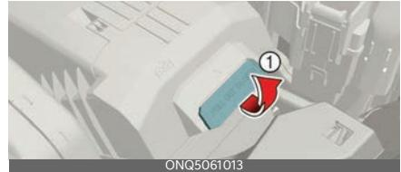
2. Gire la palanca fijada en el filtro y afloje el bloque.
