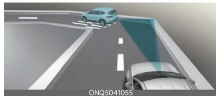
En carreteras con curvas, es posible que el control de cruceo inteligente no detecte un vehículo que esté en el mismo carril y es posible que acelere hasta la velocidad fijada. Además, la velocidad del vehículo puede reducirse rápidamente cuando se detecte
